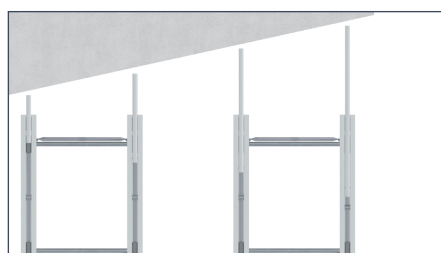
Ajuste à construção da parede A viga de inserção permite, graças aos diferentes comprimentos de extensão, um fácil ajuste das áreas das bordas.
